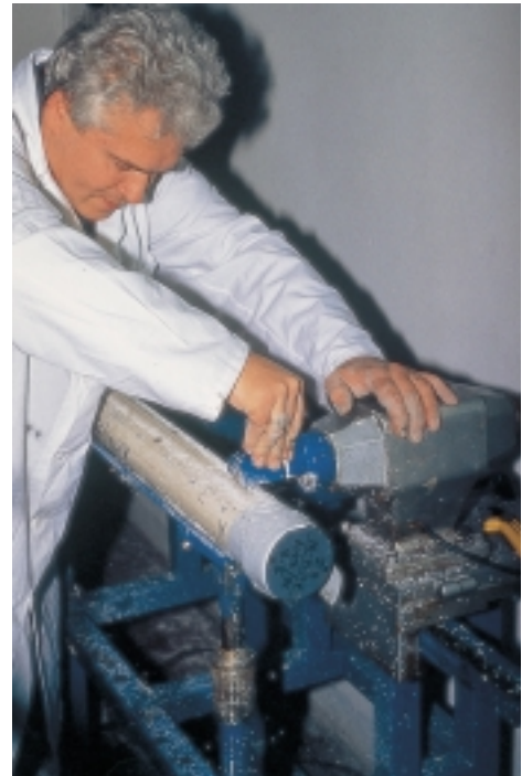
Una fase di apertura delle carote: il tubo di plastica (liner) che è stato utilizzato per imprigionare il materiale prelevato nei fondali marini antartici viene aperto tramite un seghetto circolare
